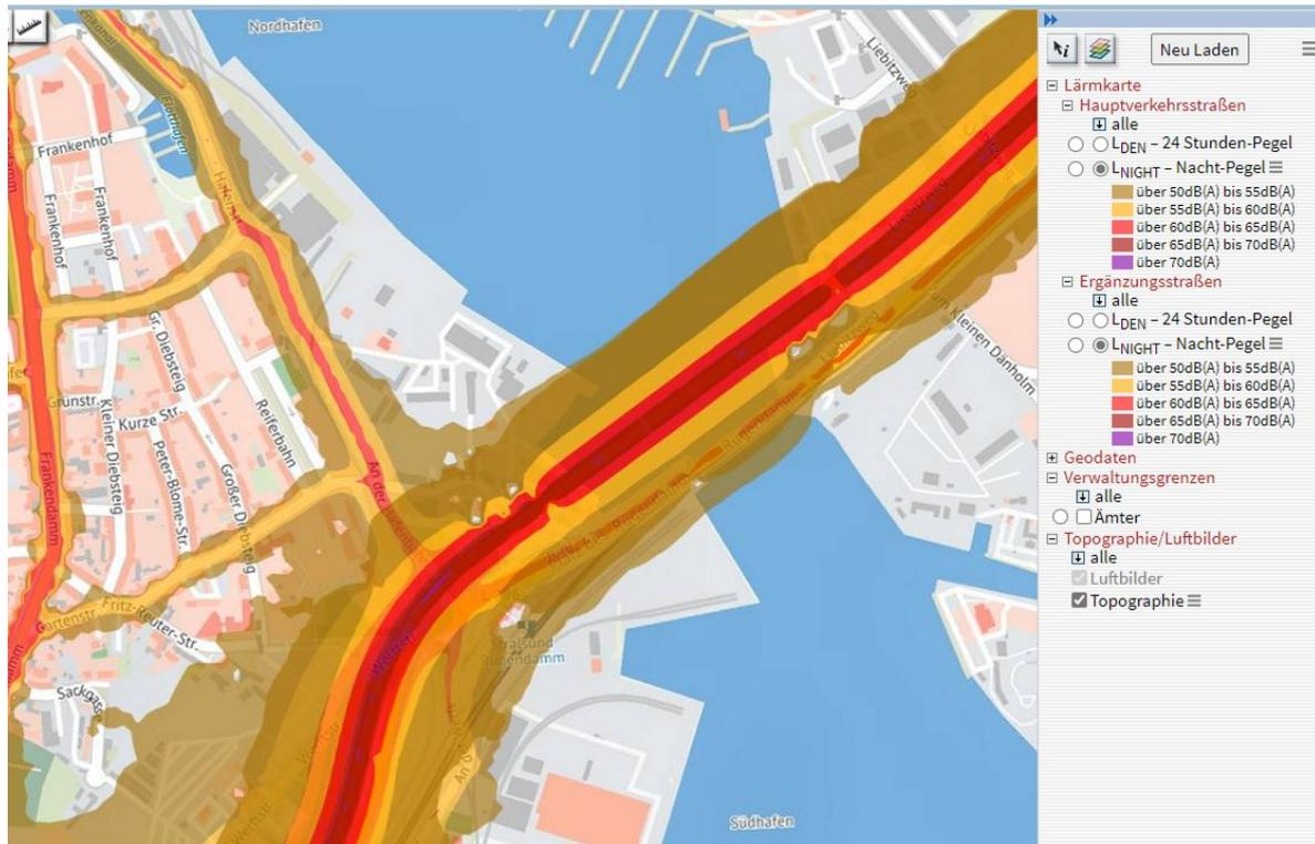
Abbildung 5: Lärmsituation für den Nachtzeitraum (L<sub>night</sub>), LUNG M-V, Lärmkartierung 2017
