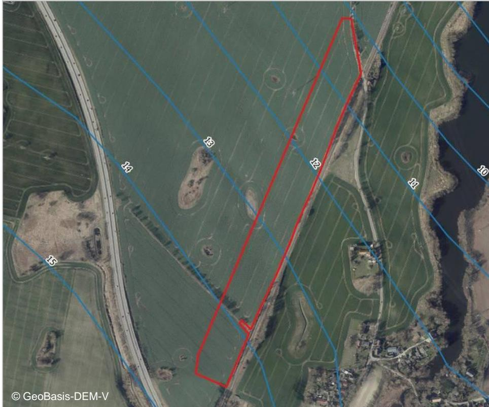
**Abbildung 6:** Grundwasserhöhengleichen (Quelle: LUNG M-V 2016).
