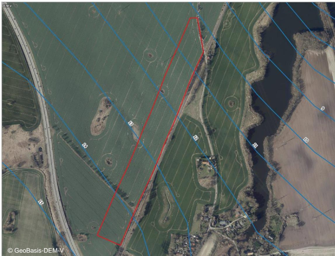
**Abbildung 4:** Grundwasserhöhengleichen (Quelle: LUNG M-V 2016)
