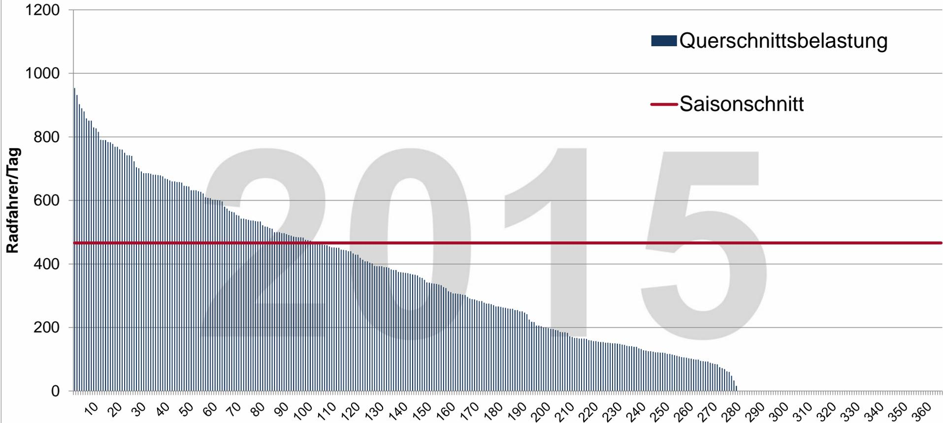
Dieses Diagramm stellt die Rangfolge der täglichen Radverkehrsmengen dar. Auf der x-Achse ist hierzu der Rang, auf der y-Achse die Anzahl der Radfahrer wiedergegeben. Es werden die täglichen Querschnittsbelastungen sowie der Saisondurchschnitt wiedergegeben. Berücksichtigt ist der Zählzeitraum in der Zeit vom 01.01.2015 bis 31.12.2015.
