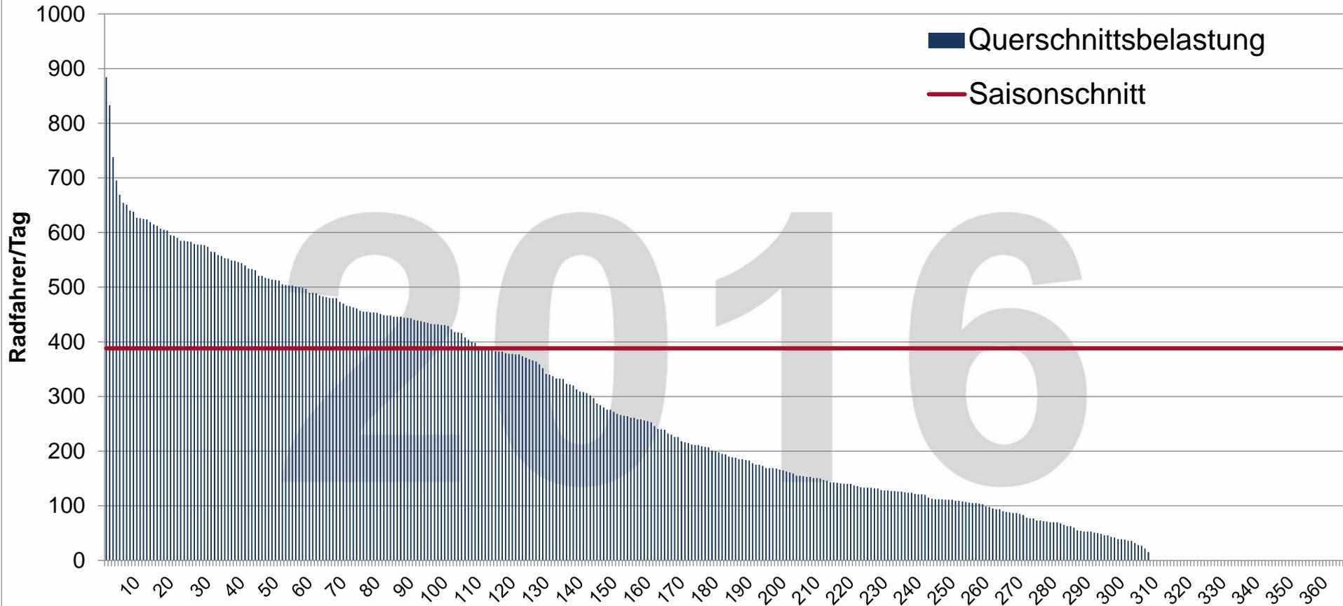
Dieses Diagramm stellt die Rangfolge der täglichen Radverkehrsmengen dar. Auf der x-Achse ist hierzu der Rang, auf der y-Achse die Anzahl der Radfahrer wiedergegeben. Es werden die täglichen Querschnittsbelastungen sowie der Saisondurchschnitt wiedergegeben.
