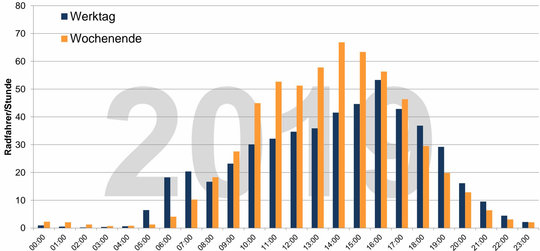
Dieses Diagramm stellt das durchschnittliche Radverkehrsaufkommen pro Stunde dar. Auf der x-Achse sind hierzu die Stunden eines Tages, auf der y-Achse die Anzahl der durchschnittlich erfassten Radfahrer wiedergegeben. Es werden Werktage und Wochenenden unterschieden.
